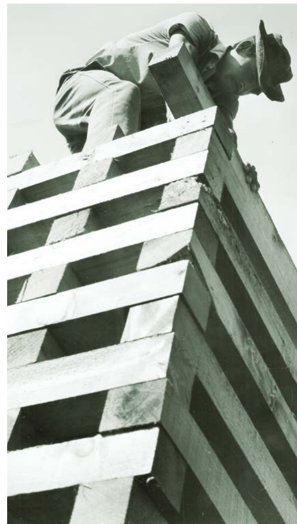
Trabalhador de serraria acomoda os vigotes em bloco arejado para facilitar a secagem. “Só Mais Este”, fotografia de João de Paula.
