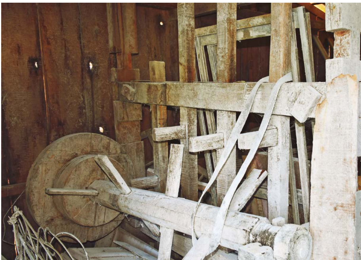
"Soque" de erva-mate da família Dalla Costa. A roda fazia subir e descer os soquetes, alternadamente, promovendo a moagem da erva. Enquanto ativo, o soque era tingido pelo verde da erva. Mas o local tornou-se depósito de farinha de trigo.
